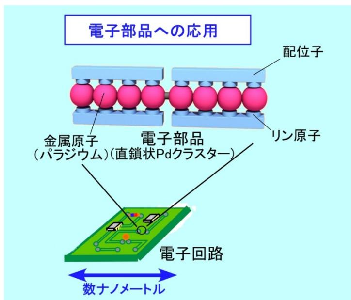
図 25 パラジウムクラスターの応用例
