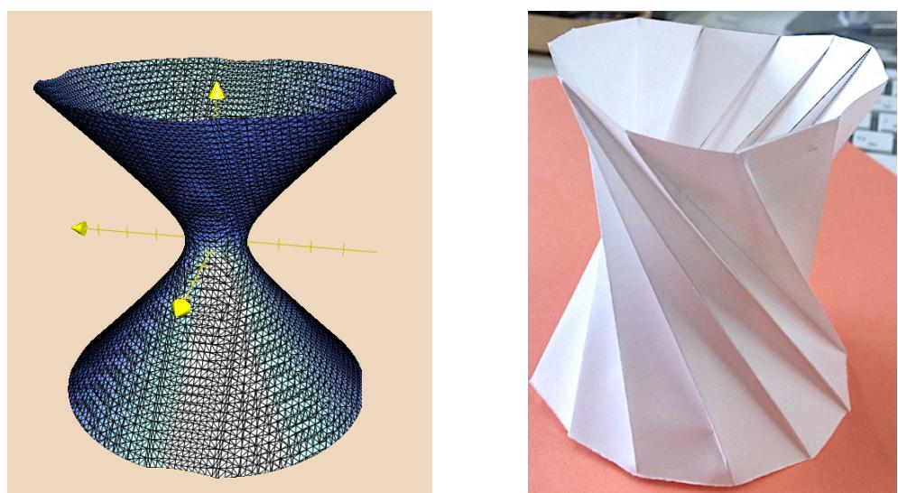
左の図は一葉双曲面と呼ばれる曲面であり、回転軸に対して傾いた線分が軸の
