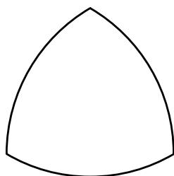
左の正三角形の各辺を膨らませたような図形はルーローの三角形と呼ばれる。これは定幅図形（差渡しの幅が常に一定となる図形）であり、高さが一定のまま転がすことができる。
