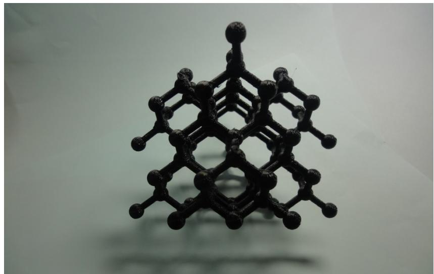
図 16c ダイヤモンド構造 ③ (すべて炭素原子からなる)
