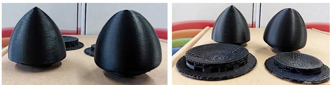
写真の左の立体はルーローの三角形を軸対称図形と考えたときの軸を中心にして回転させたものであり、定幅図形になっている。したがって、まるで球体を転がしているかのように一定の高さを保ったまま転がすことができる。写真の右の立体は、ルーローの三角形を拡張して角を丸くした図形（\*）を軸対称図形と考え、軸を中心にして回転させたものであると推測できる。この立体も定幅図形になっているようだ。
