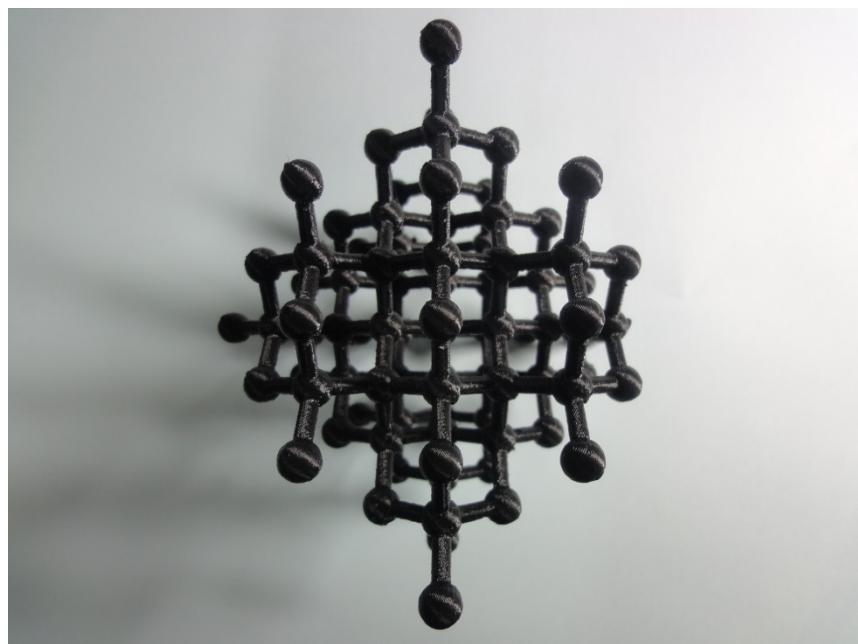
図 16b ダイヤモンド構造 ② (すべて炭素原子からなる)
