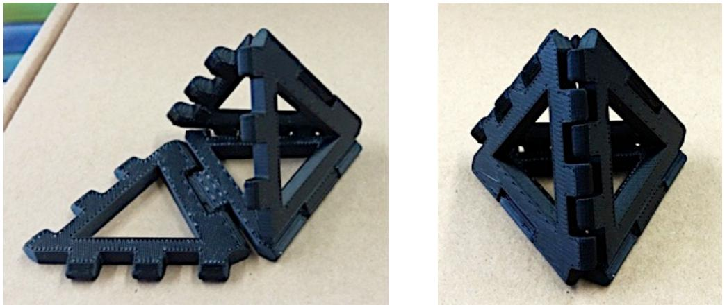
ん驚いたのは、ヒンジのある作品があまりにも簡単に出力できたことである。ヒンジの部分の凹凸がどのようにかみ合っているのかが3Dデータの中に組み込まれてあり、その通りに出力されるのでヒンジの部分がなめらかに動くのである。ただし、あまり小さいサイズで出力するとヒンジの部分がうまく稼働せず、壊れてしまう。ヒンジの部分がうまく稼働する空間を確保するために、ある程度の大きさは必要なようである。
