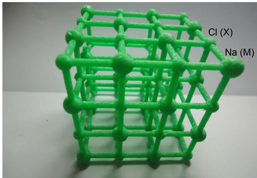
図14 塩化ナトリウム構造
