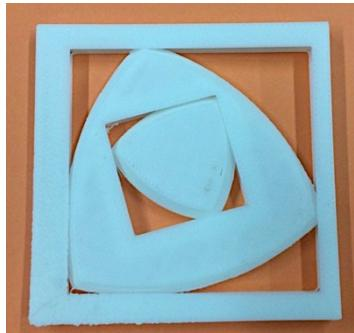
ルーローの三角形はどの方向にも幅が一定なので、正方形に内接しながら回転することが出来る。これは正方形を固定して、内側のルーローの三角形を動かすことができるようになっている。
