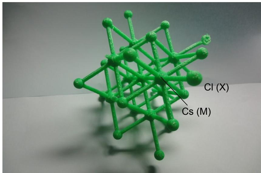
図 15 塩化セシウム構造
