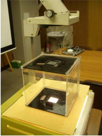
図 旋光度測定装置
