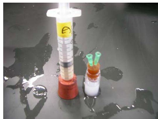
図6 実験Ⅱの結果。Aの二酸化炭素発生量が一番多かった。Aのピストンが明らかに他よりあがっている。
