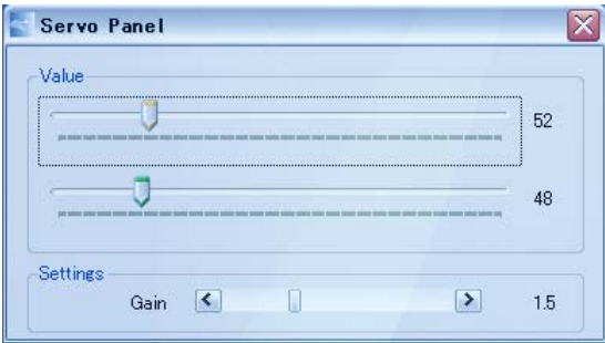
図 18 サーボモータ制御信号生成ソフト
