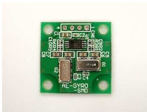
図 13 村田製作所の圧電振動ジャイロセンサ「ジャイロスター」を搭載した秋月電子通商の圧電振動ジャイロモジュール
