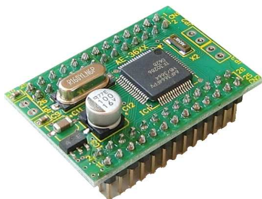
図1 H8 3664F (ルネサス エレクトロニクス, 動作周波数 16MHz)
