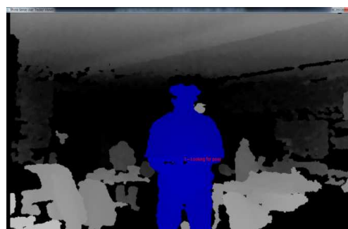
図8 OpenNI でカメラと赤外線深度 センサのデータを重ねて表示
