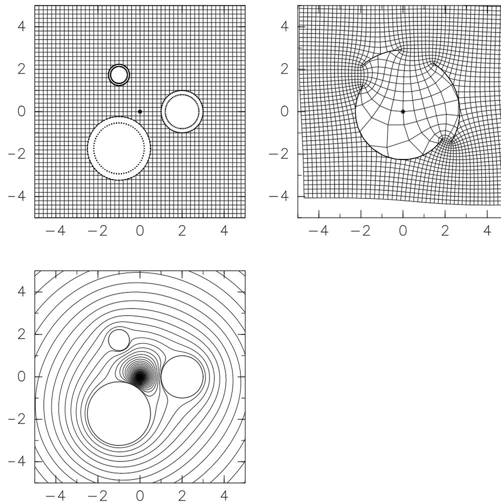
円弧スリット領域への数値等角写像  $w = F_c(z)$  と渦流  $\text{Im}(-i \log F_c(z)) = -\log|F_c(z)| = \text{const}$
