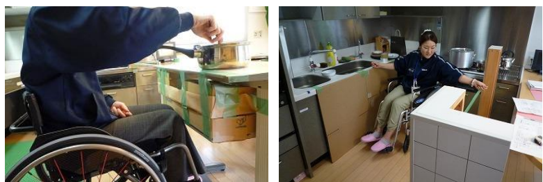
図 6. モックアップによる調理動作検証の様子
