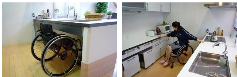
図 7. モデル住宅内に完成した車いす使用者向けキッチン
