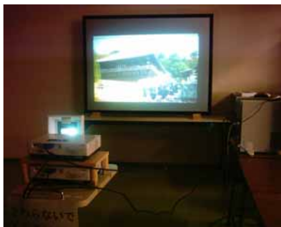
図4 偏光メガネ方式の立体視システム(プロジェクタ2台を使用)
