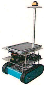
(b) 環境センシングモバイルロボット
