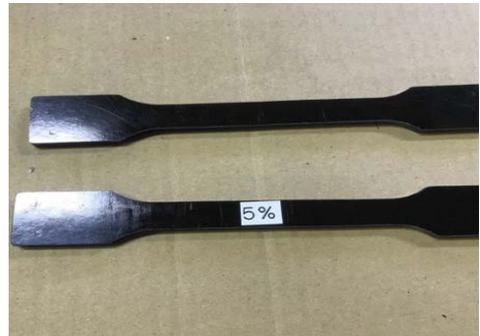
Fig. 1 CNF 複合化素材の試験片
