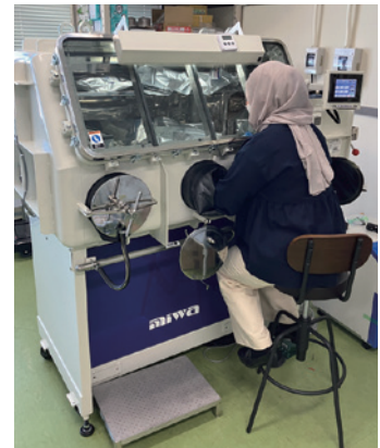
グローブボックスを用いたリチウムイオン二次電池評価セルの構築
