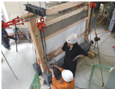
寺院建築の耐震調査
